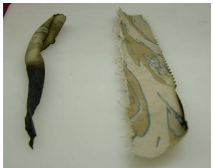
Abgebildet sind zwei Stoffproben: - eine Probe wurde mit der RST—Technologie von Alexium behandelt, die zweite nicht. Das Beispiel auf der rechten Seite erhielt eine einmalige Behandlung. Hierdurch wurde der Stoff selbstlöschend (bei einem Feuer) sowie wasser- und ölabweisend.
